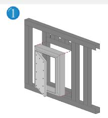
Inserire i montanti della sottostruttura esattamente su misura su entrambi i lati. Questi dovrebbero essere dei profili ad U di almeno 2 mm di spessore passanti dal pavimento al soffitto.
