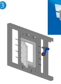
Avvitare i Profili a U con il telaio esterno della botola Jumbo.
