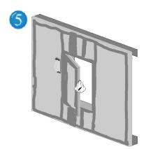
Stuccate ora il contorno del telaio esterno alla parete / soffitto di gesso rivestito, incluse le viti.
