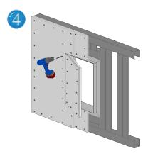
Le lastre di copertura della struttura possono essere avvitate direttamente al profilo della botola Jumbo.
