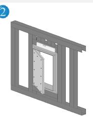
Inserire la botola assicurandosi che il montaggio sia completamente a filo del telaio. (in caso di montaggio a posteriori deve essere garantito uno sbalzo in gesso di almeno 30 mm in modo da poter inserire e avvitare il telaio della porta Jumbo)
